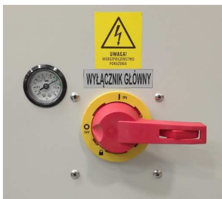
a – wyłącznik główny (prawa strona maszyny) sekcja operacyjna 1
