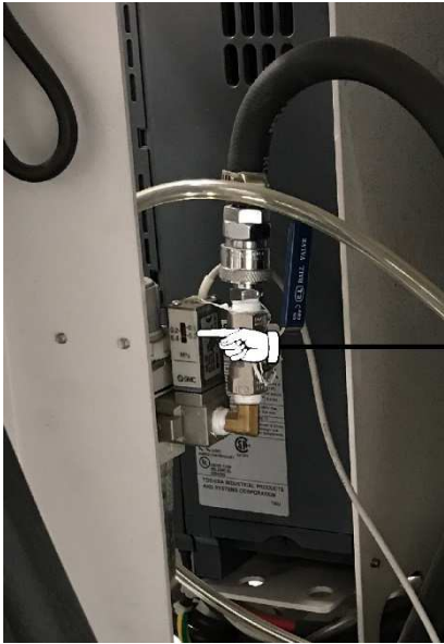
Rys. 9. Cutter automatyczny Takatori TAC-175TB – podłączenie do źródła zasilania
