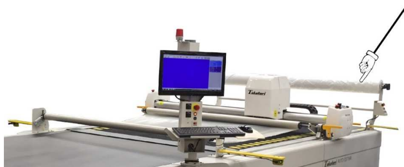
Rys. 10. Cutter automatyczny Takatori TAC-175TB – umiejscowienie wymiennego wałka z folią
