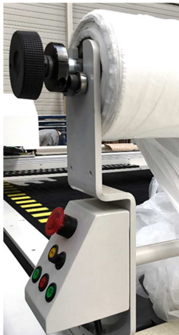
Rys. 11. Cutter automatyczny Takatori TAC-175TB – pokrętko wążka z rolką folii
